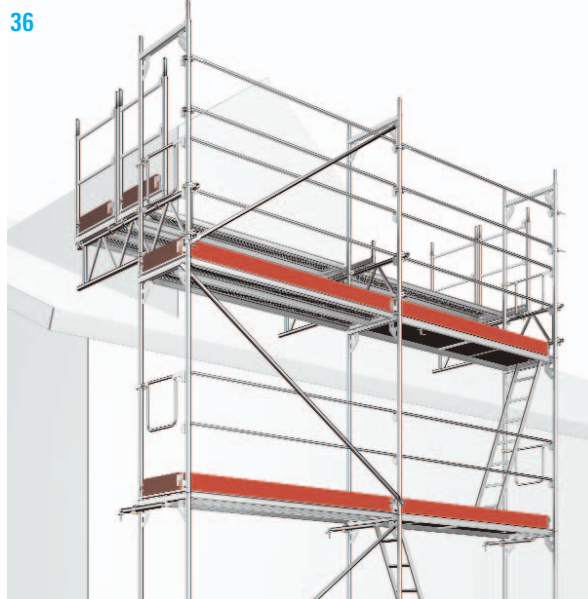
36 Collegare le travi a traliccio ai telai e fissare i correnti a U (con spinotto di collegamento tubi e mezzogiunto Rif. N. 1766.722). Assicurare i telai dell'ultimo e del penultimo piano con spine di sicurezza.
