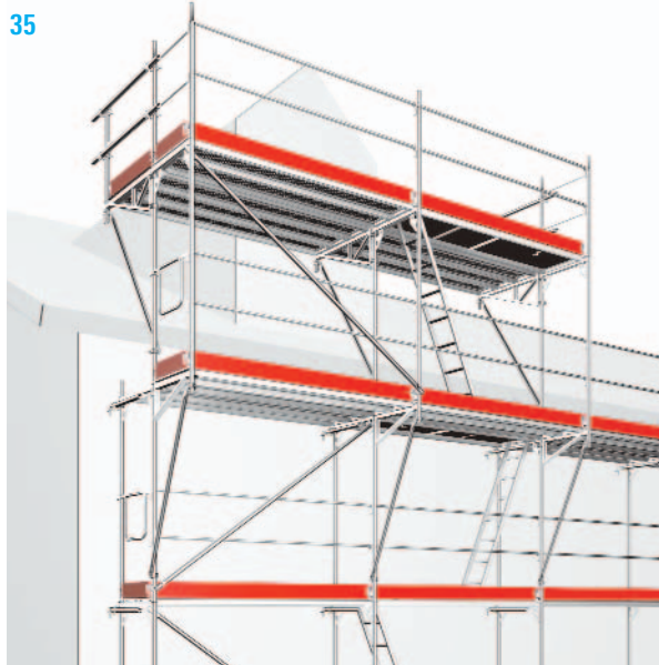
35 I telai sulle mensole vanno assicurati con spine di sicurezza.
