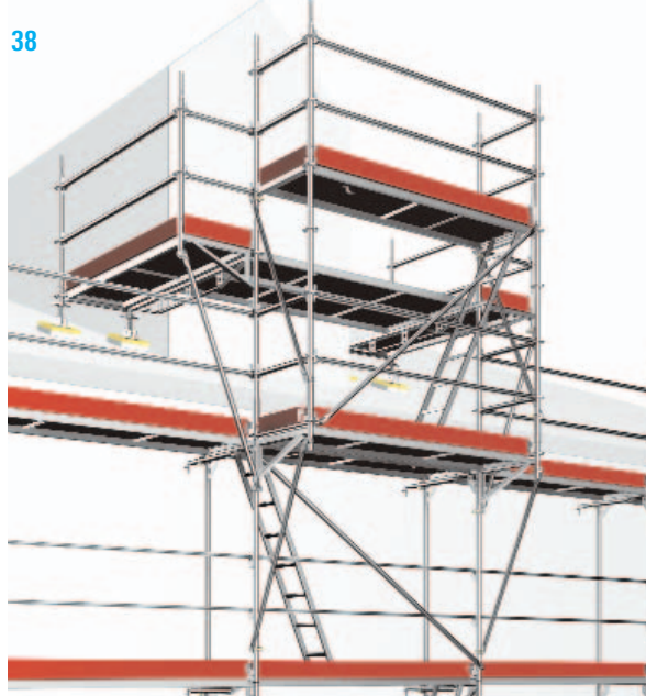
38 Avendo le stesse misure assiali, il ponteggio Blitz e il ponteggio Universale possono essere utilizzati insieme.
